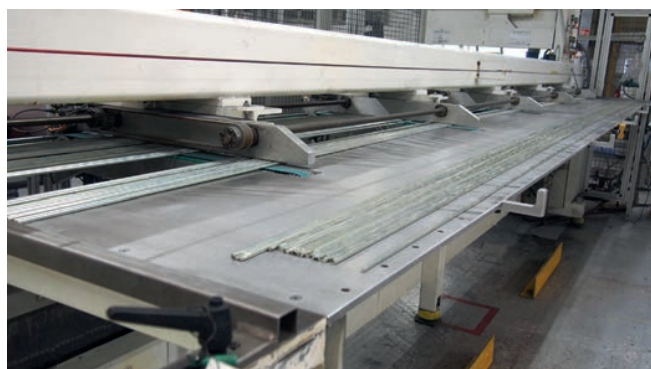
D'impressionnants embarreurs viennent alimenter des machines spéciales
